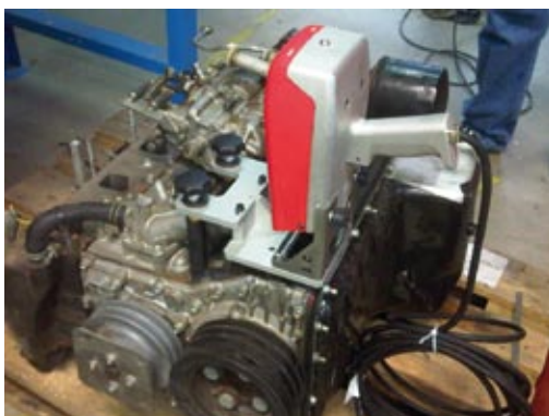
Marcaje de bloque de motor
